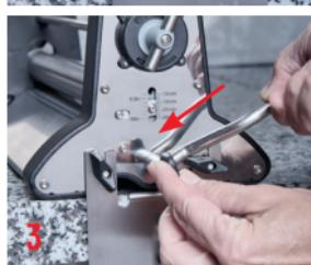
**3 -** Desserrer la vis papillon de fixation de la manivelle, insérer la manivelle dans le trou prévu sur la tige, resserrer la vis fermement. Orienter la poignée de la manivelle vers vous pour la prise en main. Le laminoir est prêt à être utilisé.
