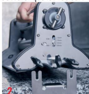
**2 -** Desserrer les vis papillons du laminoir, puis insérer le laminoir sur l'étau en le glissant dans les fentes de l'étau au niveau des vis papillon.
